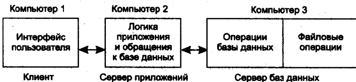
Рис. 10.2. Трехзвенная схема распределения частей приложения
