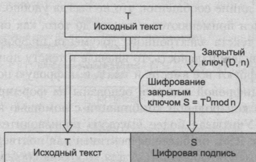
Рис. 12.11. Схема формирования цифровой подписи по алгоритму RSA
