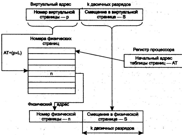
Рис. 5.15. Схема преобразования виртуального адреса в физический при страничной организации памяти
