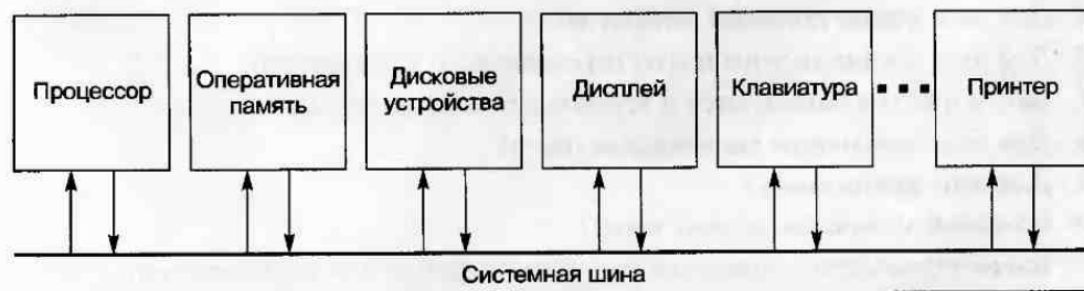
Рис. 2.4. Упрощенная схема устройства персонального компьютера
